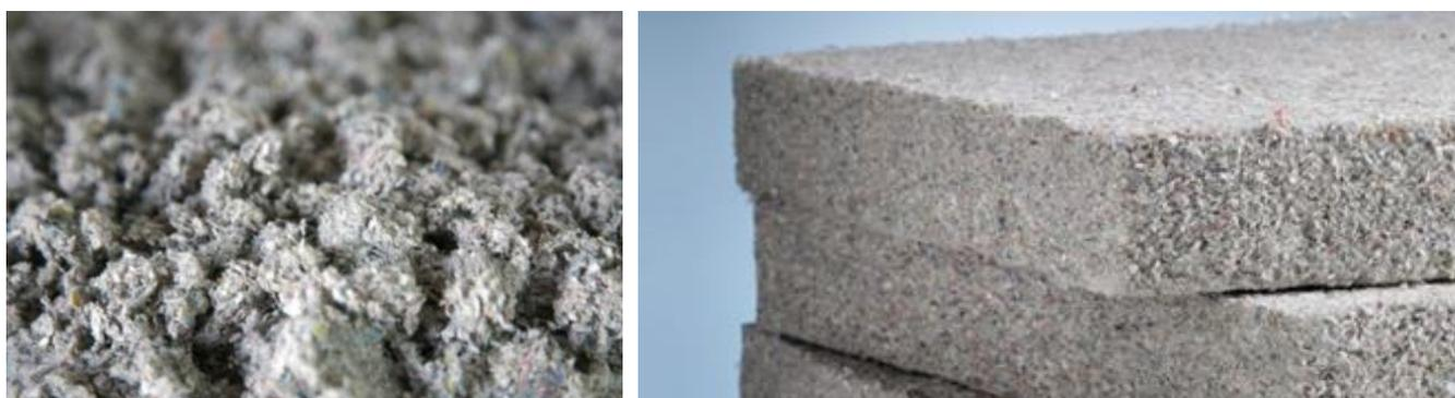
La ouate de cellulose est un matériau utilisé dans la construction. Il est classé M1, non inflammable, au titre de la classification française et B-s2-d0 au titre la classification Euroclasse. Cette dernière classification permet de mieux appréhender la réaction au feu, le mécanisme d'inflammation et de propagation de cette matière :
